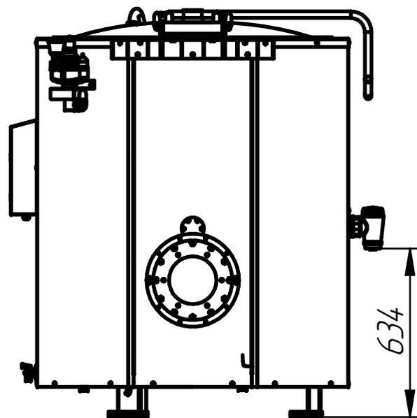
Котлы пищеварочные дизельные типа КПДМ предназначены для кипячения воды, приготовления бульонов, первых блюд, напитков, компотов и т.п.. Слив готового продукта осуществляется краном 2" на передней панели. Нагрев продуктов в сосуде осуществляется способом "пароводяной рубашки". При отсутствии воды в "пароводяной рубашке" срабатывает автоматическое отключение котла. Котел комплектуется горелкой дизельной Lamborghini ECO-7R. Возможно использование в качестве топлива газ, при замене горелки.
